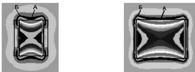
Рис. 6. Распределение магнитной индукции по высоте в образцах сердечников различной формы
