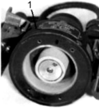
Рис. 1. Стационарный плазменный двигатель М-50 с круглой МС с одной общей наружной катушкой
